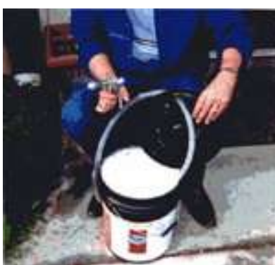
SI DETIENE LA APLICACIÓN, VACIE LA MANGERA Y LÍMPIELA CON AGUA DE ACUERDO CON LAS INSTRUCCIONES.
