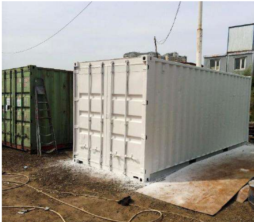
Contenedores gemelos. Uno sin aislante térmico y otro con TEMP-COAT 101
