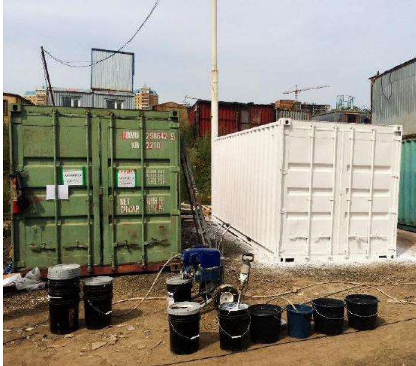
Contenedores gemelos. Uno sin aislante térmico y otro con TEMP-COAT 101
