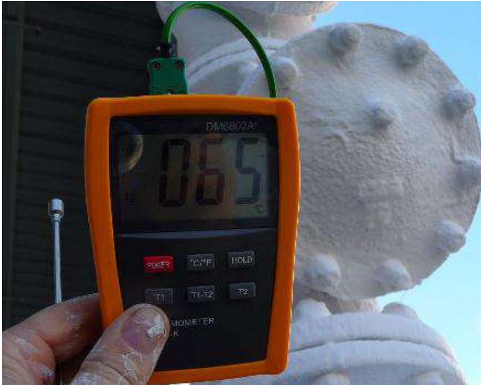
Con aislamiento TEMP-COAT®101 - 3 mm de recubrimiento TEMP-COAT®101 reduce la temperatura a 65°C
